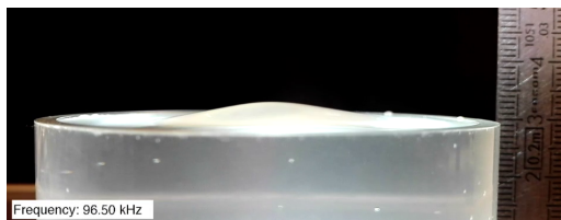
FIG1 : Déformation d'une interface eau/air par la force de radiation acoustique.
