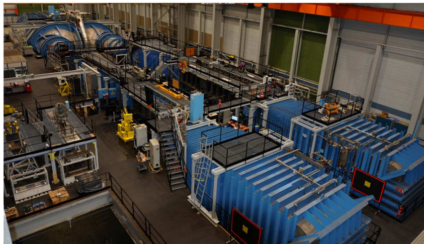
Figure 1: vue des veines d'essai du grand tunnel hydrodynamique de la DGA.
